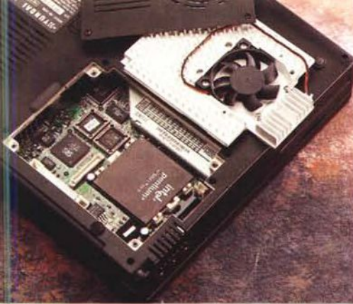
Rimossa la piastra di copertura e il dissipatore con l'originale sistema di ventilazione forzata si accede all'alloggiamento del Pentium MMX a 166 MHz.
